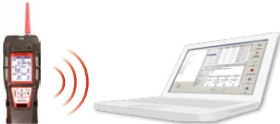
Der eingebaute Datalogger erlaubt es, Messdaten zu erfassen und diese intern zu speichern. Sie können die Daten drahtlos per Infrarot auf den PC übertragen, um vorangegangene Gefahrensituationen auszuwerten, zu protokollieren und zu dokumentieren. Zudem können mittels Datalogger Software Geräte als Geräteflotten verwaltet werden.
